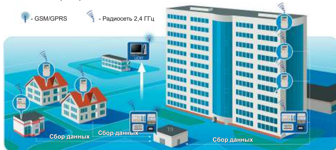
АСКУЭ (автоматизированная система коммерческого учета электроэнергии) давно известна старшим по домам в Ульяновске, которые рассматривали возможность ее установки у себя в МКД. Эта система позволяет минимизировать неучтенное потребление и свести начисления по ОДН к нулю
