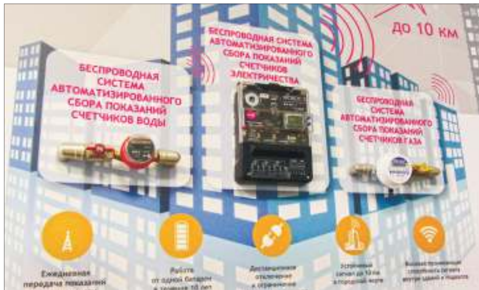
Сигналы от радиодатчиков на приборах учета в доме передаются на базовую станцию, которая может находиться на удалении до 10 км
